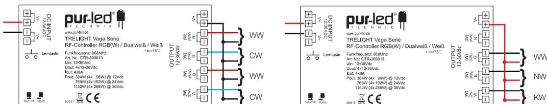
Info: Jeder Kanal kann mit bis zu 8A belastet werden, die Kanäle WW- und CW- werden jeweils gemeinsam angesteuert, die für trippleweiß werden einzeln gesteuert.
