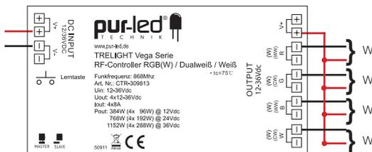
Info: Jeder W- Kanal kann mit bis zu 8A belastet werden, alle Kanäle werden gemeinsam angesteuert.
